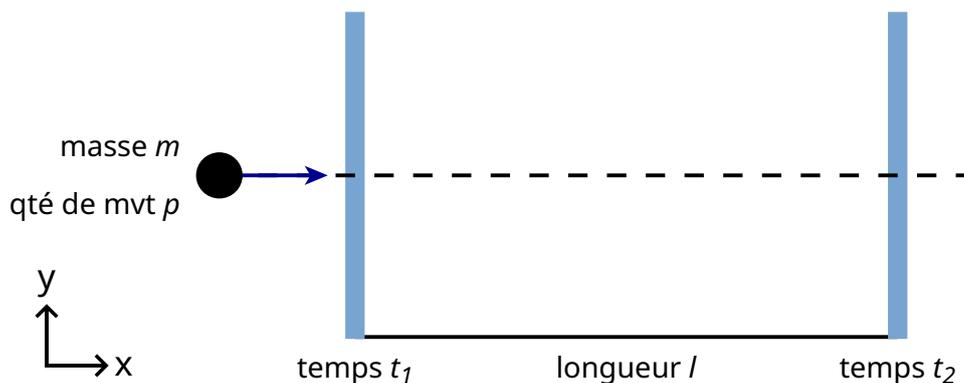
Figure 2 : Schéma d'un détecteur de temps de vol.
